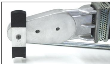
01- A presilha é termofusionada no tubo, formando com este, um conjunto solidário. Para esta operação utiliza-se um "dispositivo de presilha" montado na termofusora.
